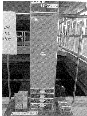
急速ろ過層の構成(一例)
